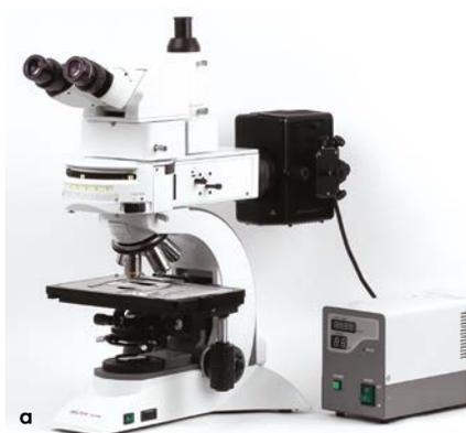
Рисунок 6. Конструкции прямого (а) и инвертированного (б) люминесцентного микроскопа Micros.
