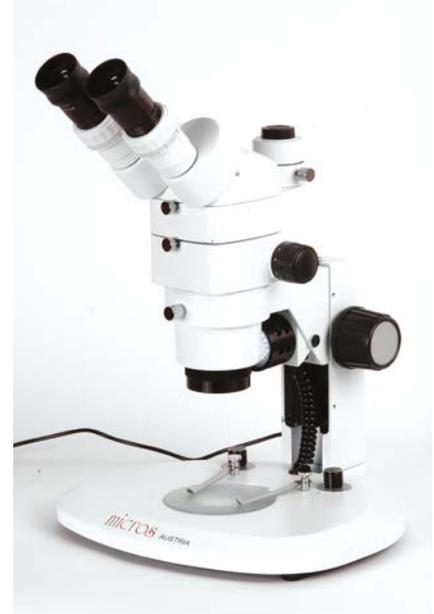
Рисунок 2. Стереомикроскоп Micros MC 800: zoom 1:8,3; базовое увеличение 6–50× (максимум 225×); базовое рабочее расстояние 95 мм; максимальное поле на предмете 36,6 мм; окуляры 10×/22 мм; проходящий и падающий свет.
