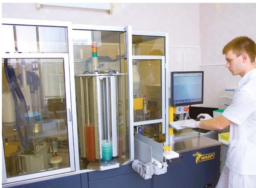
Рисунок 1. Оснащение микробиологической лаборатории ККБ № 2 системой WASP для автоматизации бактериологического посева.
